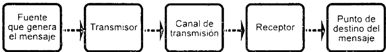
Fig. 1-1 Elementos fundamentales de un sistema de comunicaciones.
